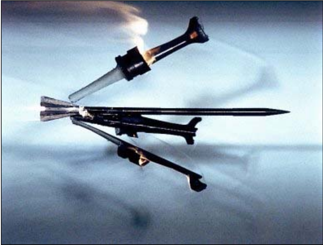
Fig 2.3. Drivspeil frigjøres fra pilen i et amerikansk prosjektil av typen M829 (utarmet uran, 120 mm kaliber).
