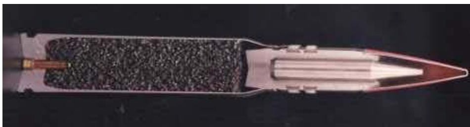
Fig 2.6. Hel patron (drivladning og prosjektil) av 30 mm ammunisjon med kjerne av utarmet uran (PGU-14/B) (10).
