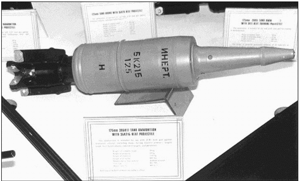
Figur 2.4. Russisk stridsvognsgranat 3BK21B. Dette er den eneste kjente hulladningsammunisjonen med utarmet uran (10).
