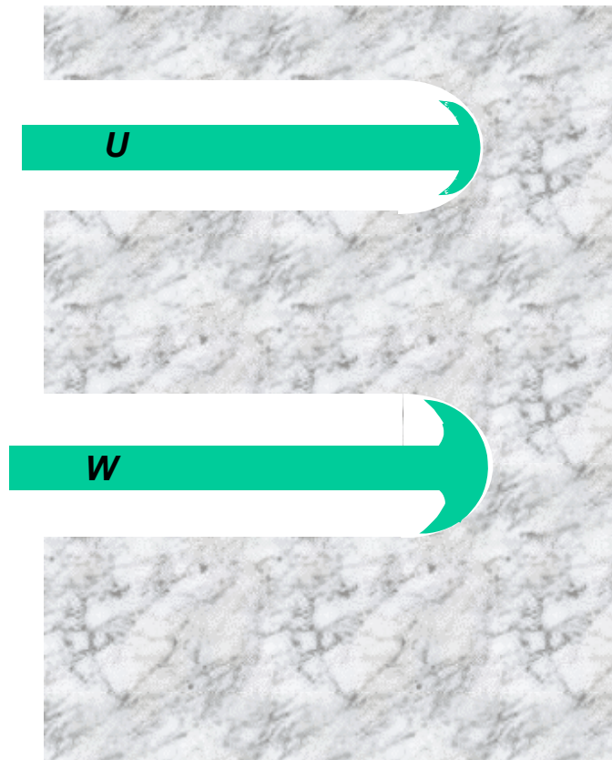
Fig 2.5. Penetrasjon med utarmet uran ( U ) og wolfram ( W ). Forskjellen ligger i radien på den stukede fronten.
