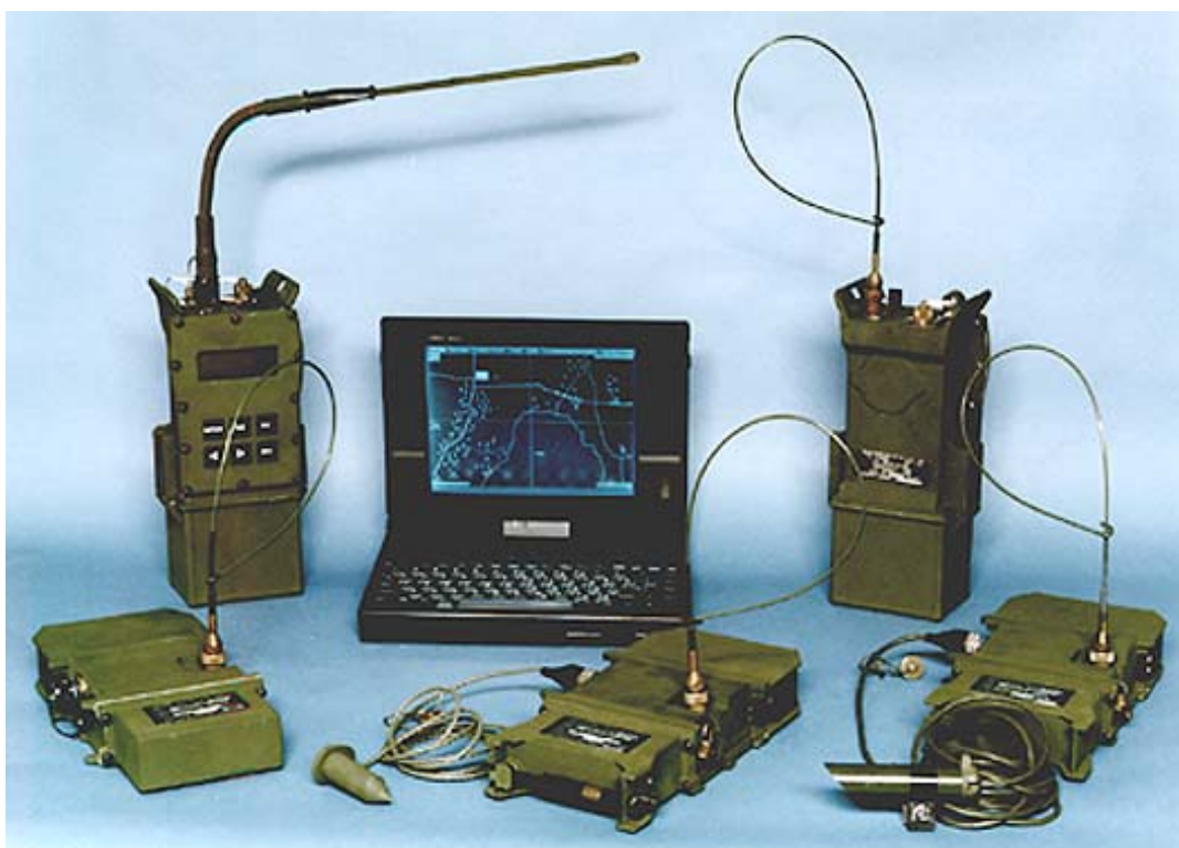
Figur 4.6 REMBASS system for deteksjon ved hjelp av magnetiske, seismiske/akustiske og infrarøde sensorer (kilde: www.army-technology.com )
