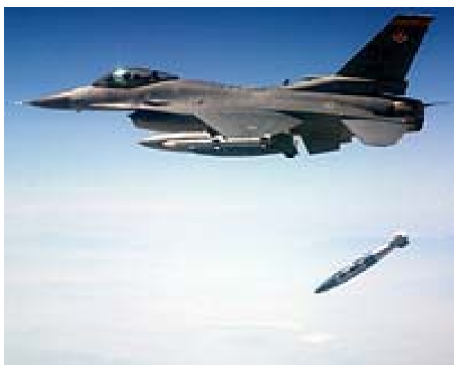
Figur 3.1 GPS-styrte JDAM-bomber bidrar til vesentlig mer kost/effektive luft-til-bakke operasjoner mot mål med kjent posisjon
