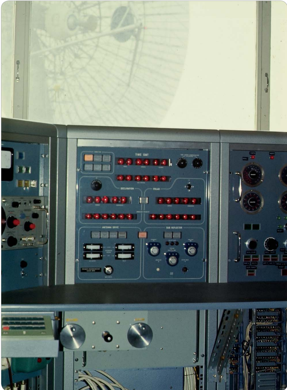
Den spesielle datamaskinen "Rasmus" ble utviklet ved FFI for å styre antennen etter nøyaktig beregnede siktevinkler, som stasjonen fikk fra USA for en uke om gangen. Bildet viser fronten på Rasmus med antennen i bakgrunnen.
