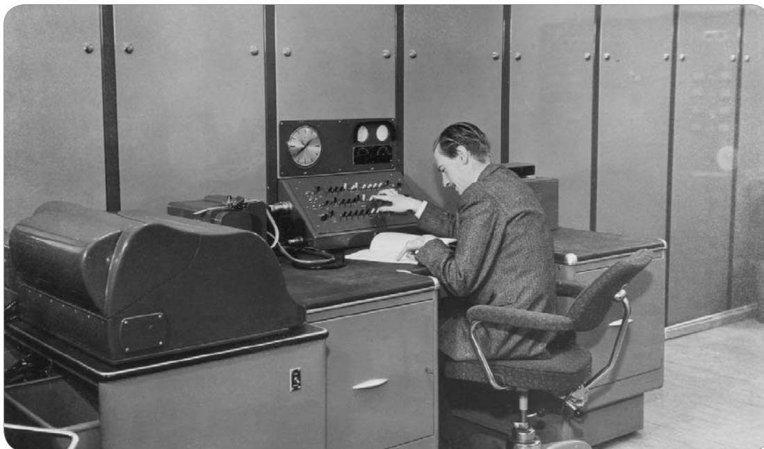
Harald Keilhau med FREDRIC, FFIs første digitale datamaskin med 2000 vakuumsrør og 20 kW varmetap.
