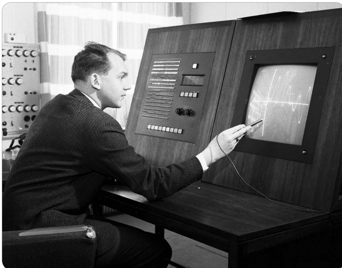
SAM hadde en spesiellaget operatørpult. Innholdet av regneregistrene ble vist av lamper og kunne endres ved et sett av brytere for feilfinning. Innmating av programmer skjedde via papirhullbånd eller direkte via "Flexowriter". En avansert dataskjerm kunne vise tekst og figurer og kunne også styres ved hjelp av "lyspenn". SAM er fra 1973 utstilt på Norsk Teknisk Museum i Oslo. Bildet viser Rolf Skår i arbeid med SAM.
