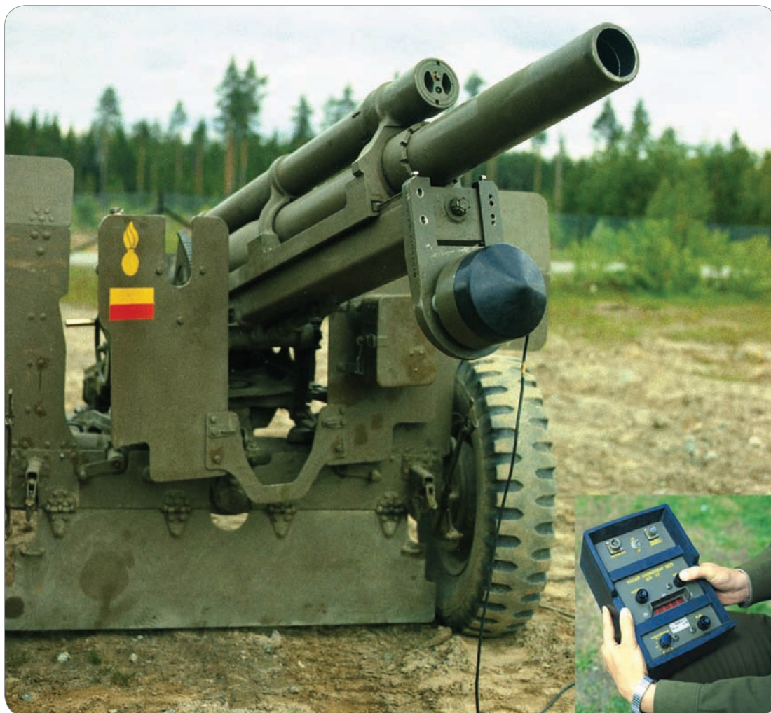
Vo-måler montert på skyts. Kontrollenheten innfelt.
