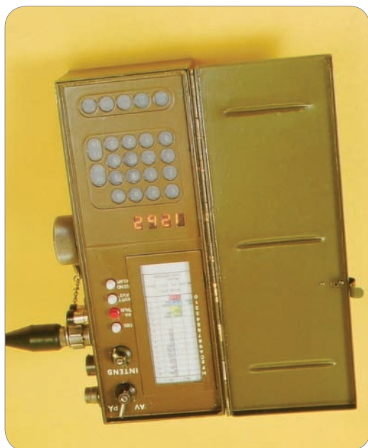
"Datsender." Meldingsgenerator med modem tilpasset ordinære feltradiostasjoner for bruk i DP. FFI-versjon.
