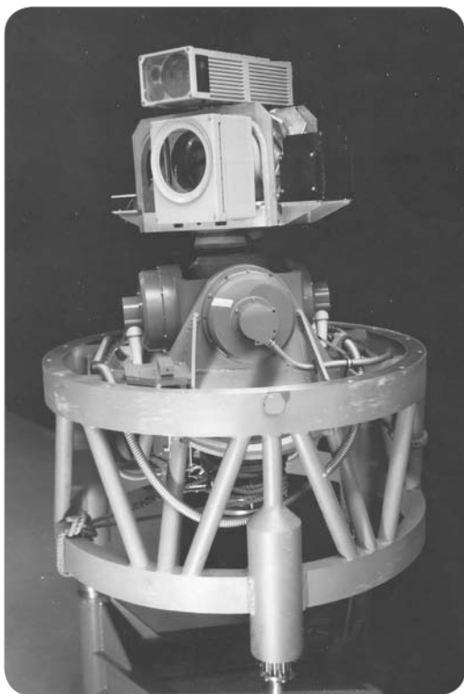
Treghetsplattform med sensorpakken, men uten værdom og sidedekslar.
