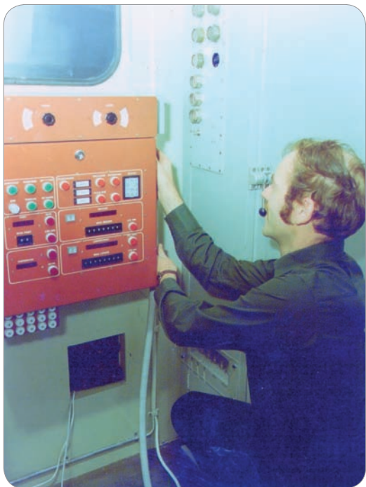
Idar Stafne monterer plattformens kontroll-enhet i prøvebilen.
