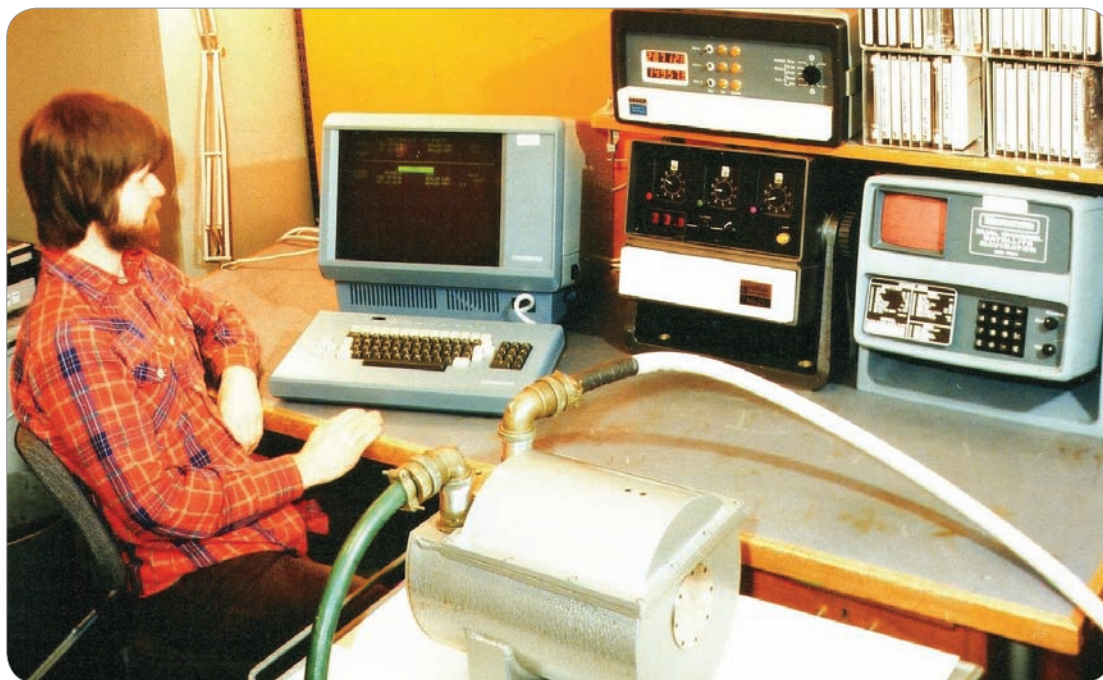
Fra utprøvingen på laboratoriet i Styrehuset. Dag Jarfonn holder oppsikt med MINAS, i forgrunnen, Transit-mottakeren til høyre, i midten Loran-C øverst, Decca nederst. Systemet kontrolleres fra Tandberg-terminalen til venstre i bildet.
