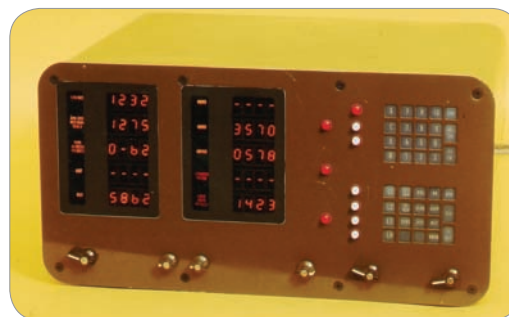
Datsender/mottaker, plassert sammen med "Skytedata-fordeler og "Feltregnemaskin" i "kommando-vogn." Administrerer ildledning i FA-batteri og FA-bataljon. FFI-versjon.
