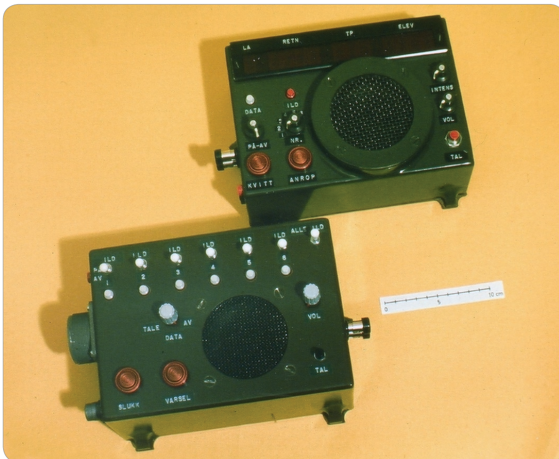
Skytedatasettet består av "Skytedatafordeler", nederst og "Skytedataindikator". "Skytedata fordeler" står i batteri-ko og fordeler skytedata til de enkelte skyts i batteriet. "Skytedataindikator" er montert på skytset og presenterer skytedata for skytsbetjeningen. FFI-versjon.
