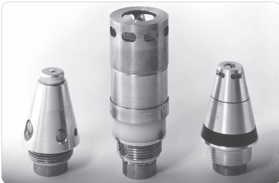
Anslagsbrannrør til venstre, NVT-1 i midten og NVT-2 til høyre.
