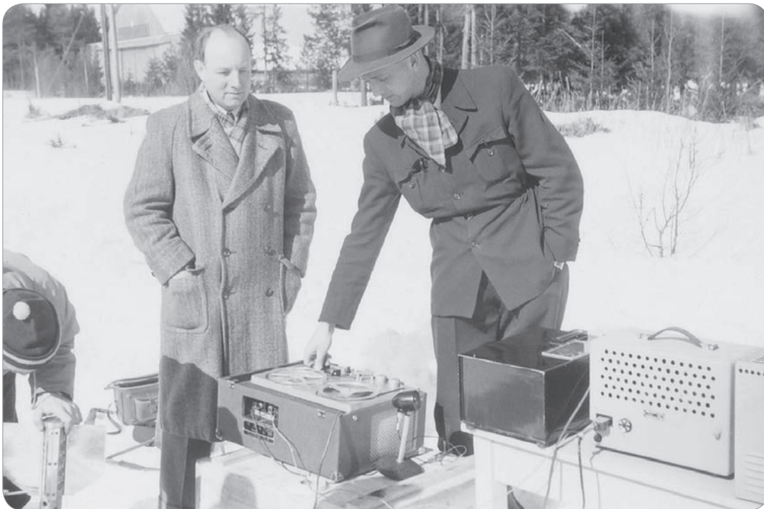
Innledende forsøk på Gardermoen. Bjarne Storm (t.v.) og Christian Holm måler variasjon i feltstyrke fra sendere sluppet fra fly. Tidlig på 1950-tallet.
