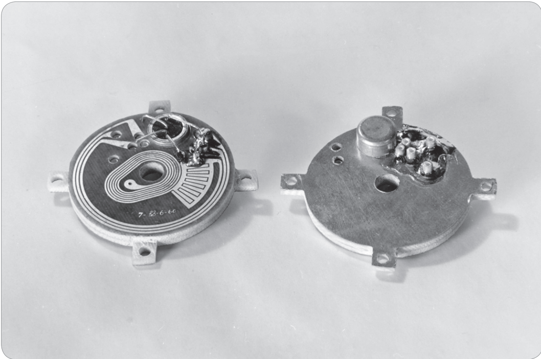
Oscillatorens kretskort. T.v. svingespole med tilbakekoblingskondensator. T.h. jordplanet på undersiden.
