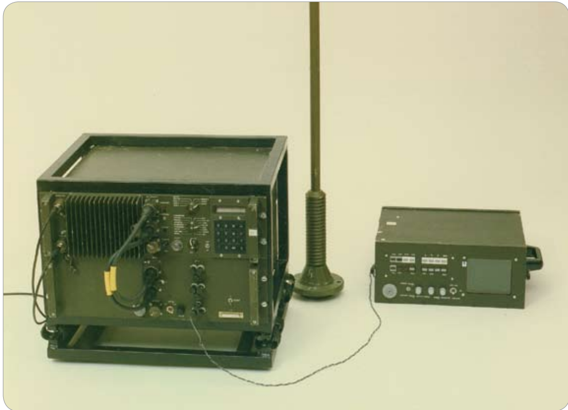
KOBRA radio og NAU med våpenterminal.
