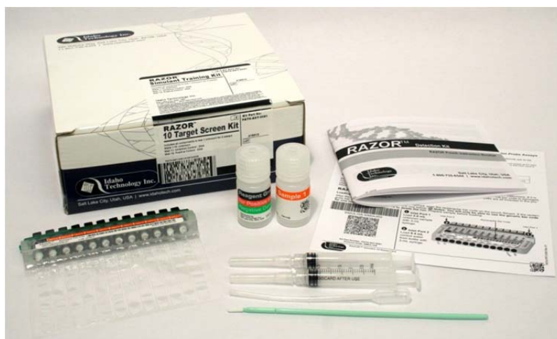
Figur 1.7 RAZOR™ EX instrumentet benytter ”The 10 Target Screen Kit” og inneholder en reagenskassett, utstyr til prøvetaking, en buffer til prøvepreparering og en buffer til positiv kontroll.
