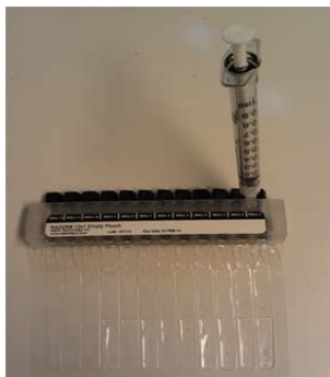
Figur 1.9 En sprøyte brukes til å overføre prøven til reagenskassetten "loading-stasjon".
